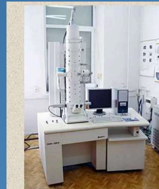
Мікроскоп електронний растровий з системою енерго-дисперсного мікроаналізу РЕМ-106И
