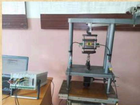
Процес тарування тензорезисторів на універсальному пресі УП-8
